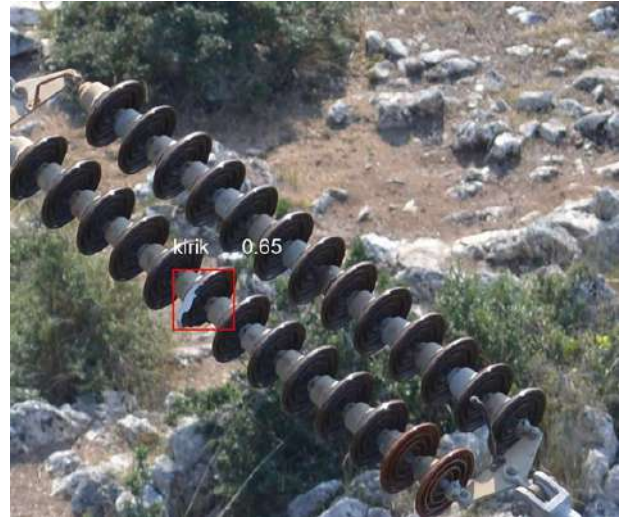
Şekil 8 İzolatörde kırık parça arızası
