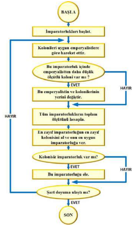
Şekil 2. Geleneksel ERA algoritmasının akış şeması.
