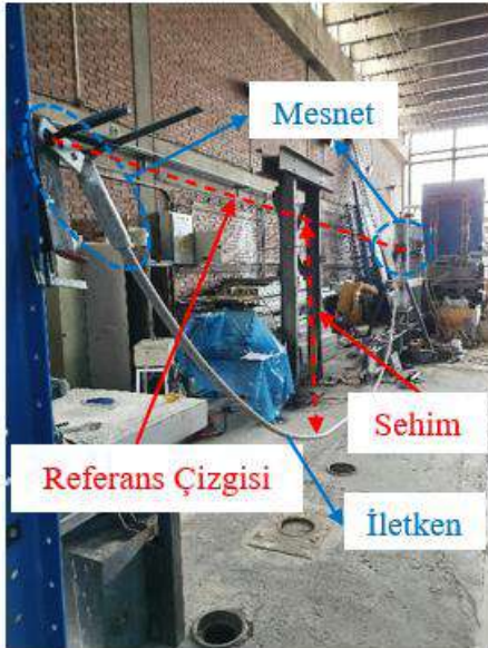
Şekil 6. Camper iletken sehim profilinin belirlenmesi için kullanılan test düzeneği
