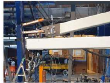
Şekil 3. (a) Tasarlanan kompozit konsolun üç boyutlu görüntüsü; (b) Konsol uç bölgesi bağlantı detayı; (c) Konsol mesnet bölgesi bağlantı detayı
