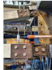
Şekil 3. (a) Tasarlanan kompozit konsolun üç boyutlu görüntüsü; (b) Konsol uç bölgesi bağlantı detayı; (c) Konsol mesnet bölgesi bağlantı detayı
