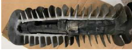
Şekil 1. Kesintili toprak arızası sonrası zarar gören bir parafudr: B faz Parafudru
