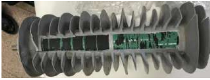
Şekil 2. Kesintili toprak arızası sonrası zarar gören bir parafudr: A faz Parafudru
