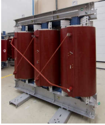
Şekil 3. Tasarlanan kuru tip trafo [ELTAŞ izniyle]
