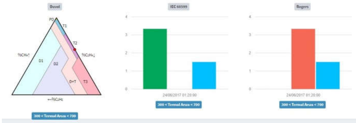
Şekil 6. Çözülmüş gaz analizi izleme ekranı
