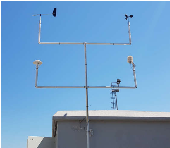
Şekil 3. Sahaya montajı yapılan hava ölçüm istasyonu
