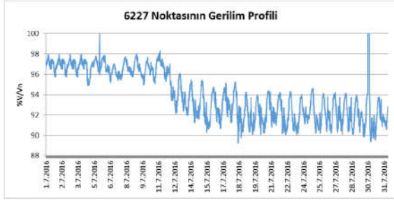
Şekil 7. GES'lerin reaktif güç kontrolüne katılmadığı durumda 6227'nin (şebekede en fazla gerilim düşümü olan nokta) gerilim profili
