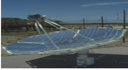
Şekil 2. Adavonco/Vanguard 25kWe Çanak/Stirling Sistemi[24]
