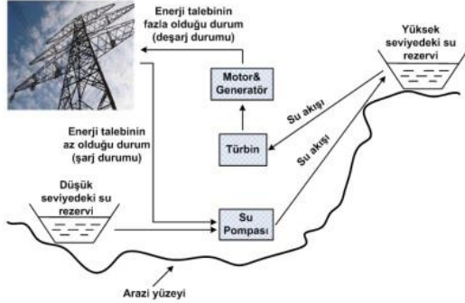
Şekil 2. Pompa depolamalı hidroelektrik sistemler
