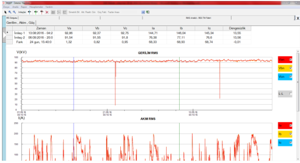
Şekil 4. Faz açısı dengesizliğinden kaynaklı bir gerilim dengesizliği limit aşımı (RES fideri)
